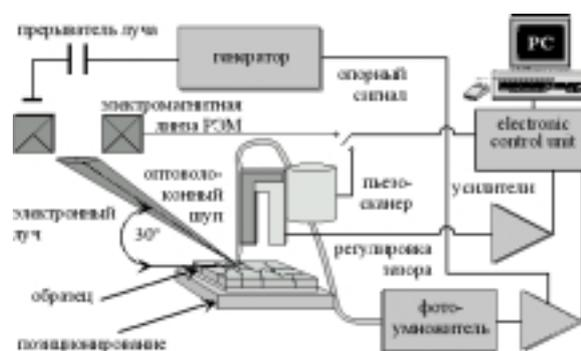
Рис.2. Блок-схема системы ближнеполевого катодоллюминесцентного микроанализа
