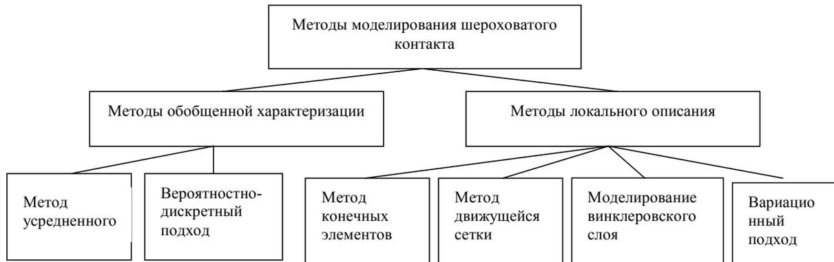
Рис. 1. Классификация методов моделирования шероховатого контакта
